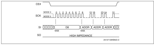
FIGURE 4-12: 64-KBYTE BLOCK-ERASE SEQUENCE
