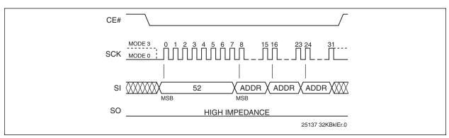
FIGURE 4-11: 32-KBYTE BLOCK-ERASE SEQUENCE
