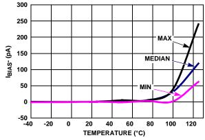
FIGURE 28.  $I_{BIAS}$ - vs TEMPERATURE  $V_+$ ,  $V_- = \pm 2.5 V$
