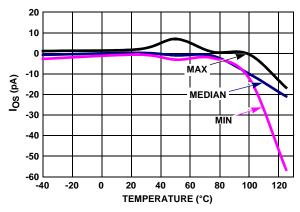
FIGURE 31. I<sub>OS</sub> vs TEMPERATURE V<sub>+</sub>, V<sub>-</sub> = ±1.2V
