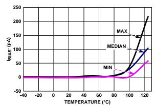
FIGURE 29. I<sub>BIAS</sub>- vs TEMPERATURE V<sub>+</sub>, V<sub>-</sub> = ±1.2V
