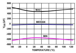
FIGURE 23.  $V_{OS}$  (SOT PKG) vs TEMPERATURE  $V_{IN}$  = 0V,  $V_+$ ,  $V_-$  = ±2.75V
