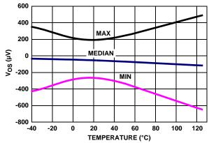
FIGURE 22.  $V_{OS}$  (SOIC PKG) vs TEMPERATURE  $V_{IN}$  = 0V,  $V_+$ ,  $V_-$  = ±2.75V
