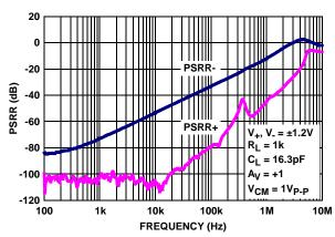
FIGURE 10. PSRR vs FREQUENCY,  $V_+$ ,  $V_- = \pm 1.2V$
