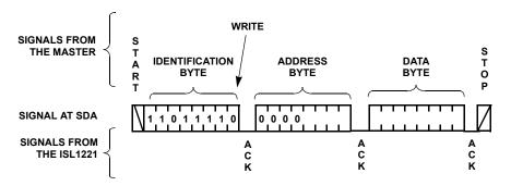
FIGURE 16. BYTE WRITE SEQUENCE
