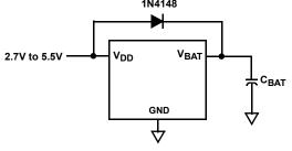
FIGURE 23. SUPERCAPACITOR CHARGING CIRCUIT
