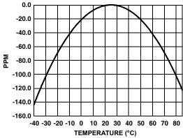
FIGURE 20. RTC CRYSTAL TEMPERATURE DRIFT
