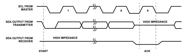
FIGURE 15. ACKNOWLEDGE RESPONSE FROM RECEIVER
